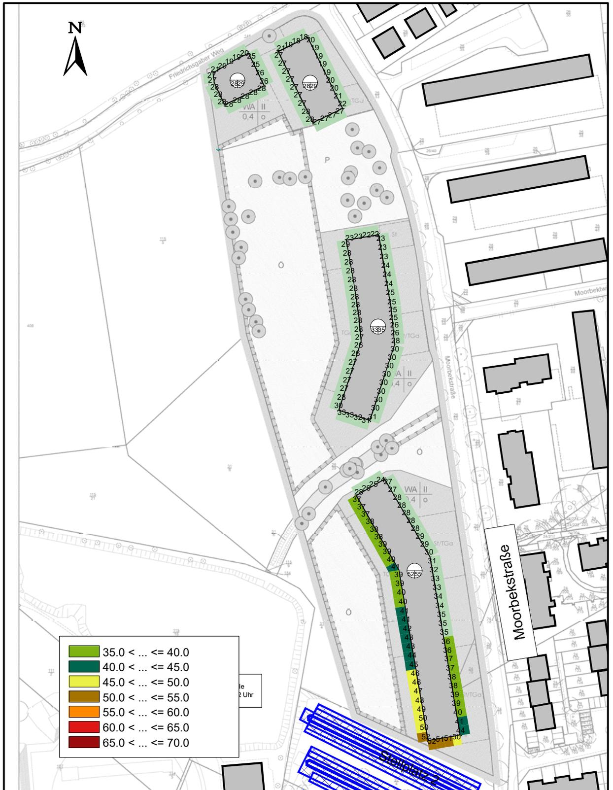
Abbildung 9. Fassadenscharfe Beurteilungspegel aus Sportlärm, Großveranstaltungen (seltenes Ereignis), innerhalb der Ruhezeiten tags [dB(A)], Maßstab 1 : 2.000.
