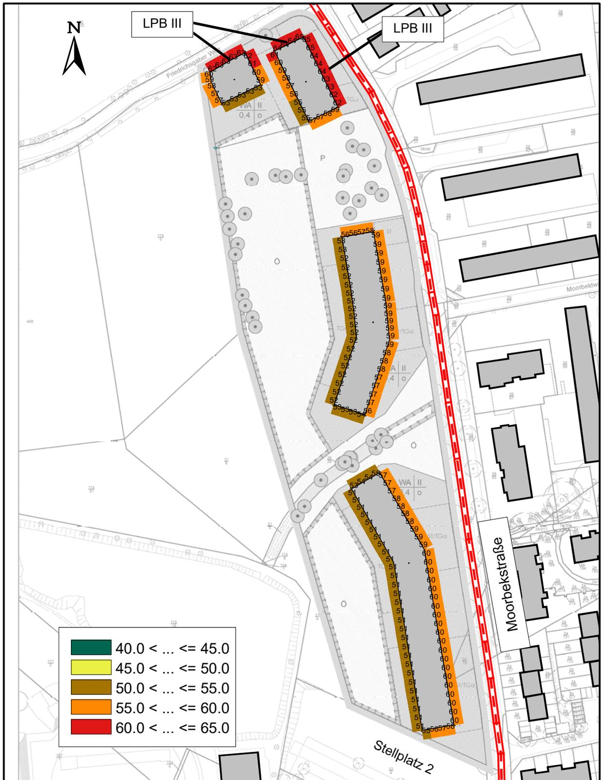
Abbildung 5. Lärmpegelbereiche nach DIN 4109 [dB(A)], Maßstab 1 : 2.000.
