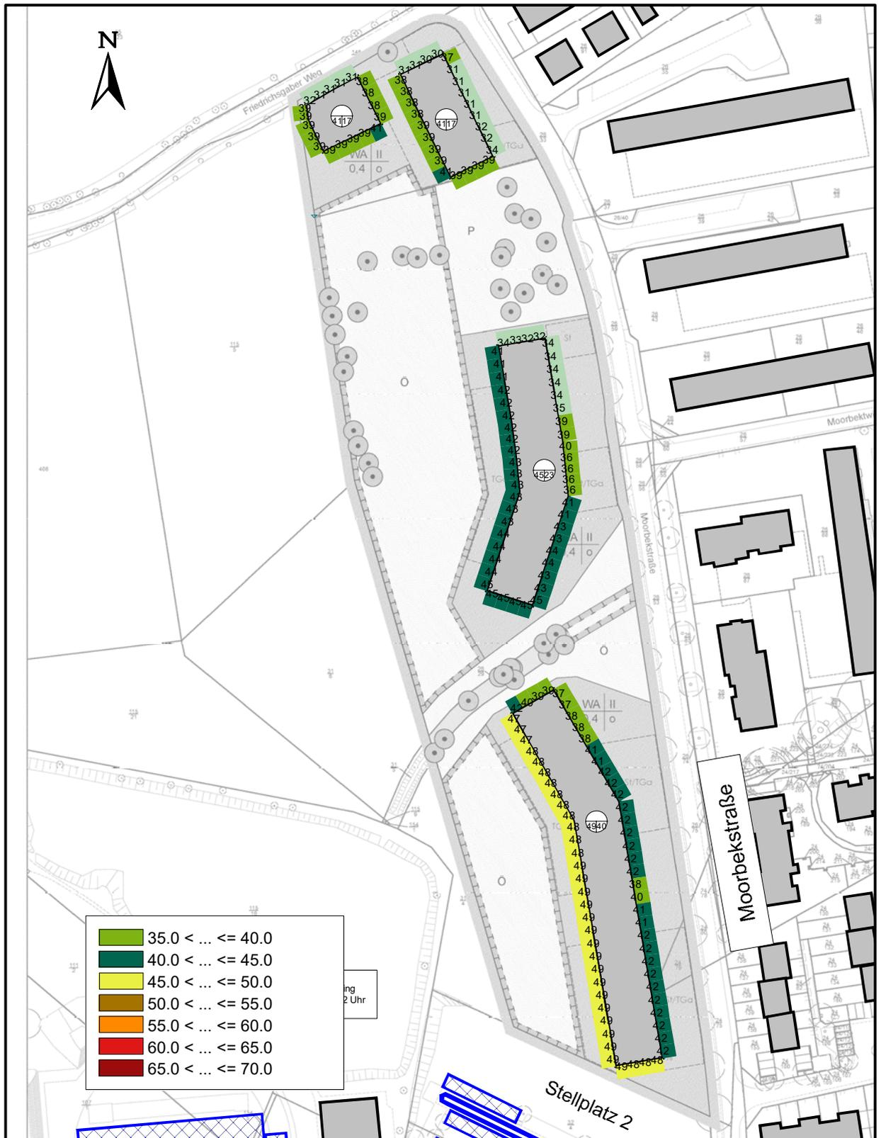
Abbildung 6. Fassadenscharfe Beurteilungspegel aus Sportlärm, Fußballtrainingsspiele, innerhalb der Ruhezeiten tags [dB(A)], Maßstab 1 : 2.000.
