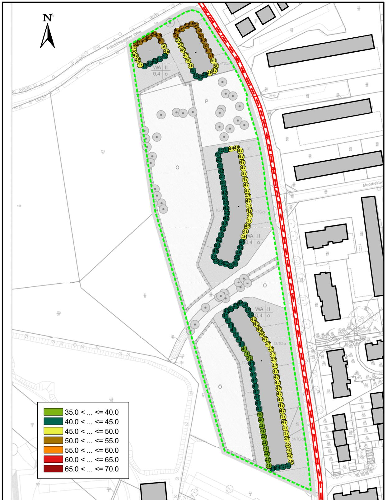
Abbildung 3. Fassadenscharfe Beurteilungspegel aus Verkehrslärm, nachts [dB(A)],
