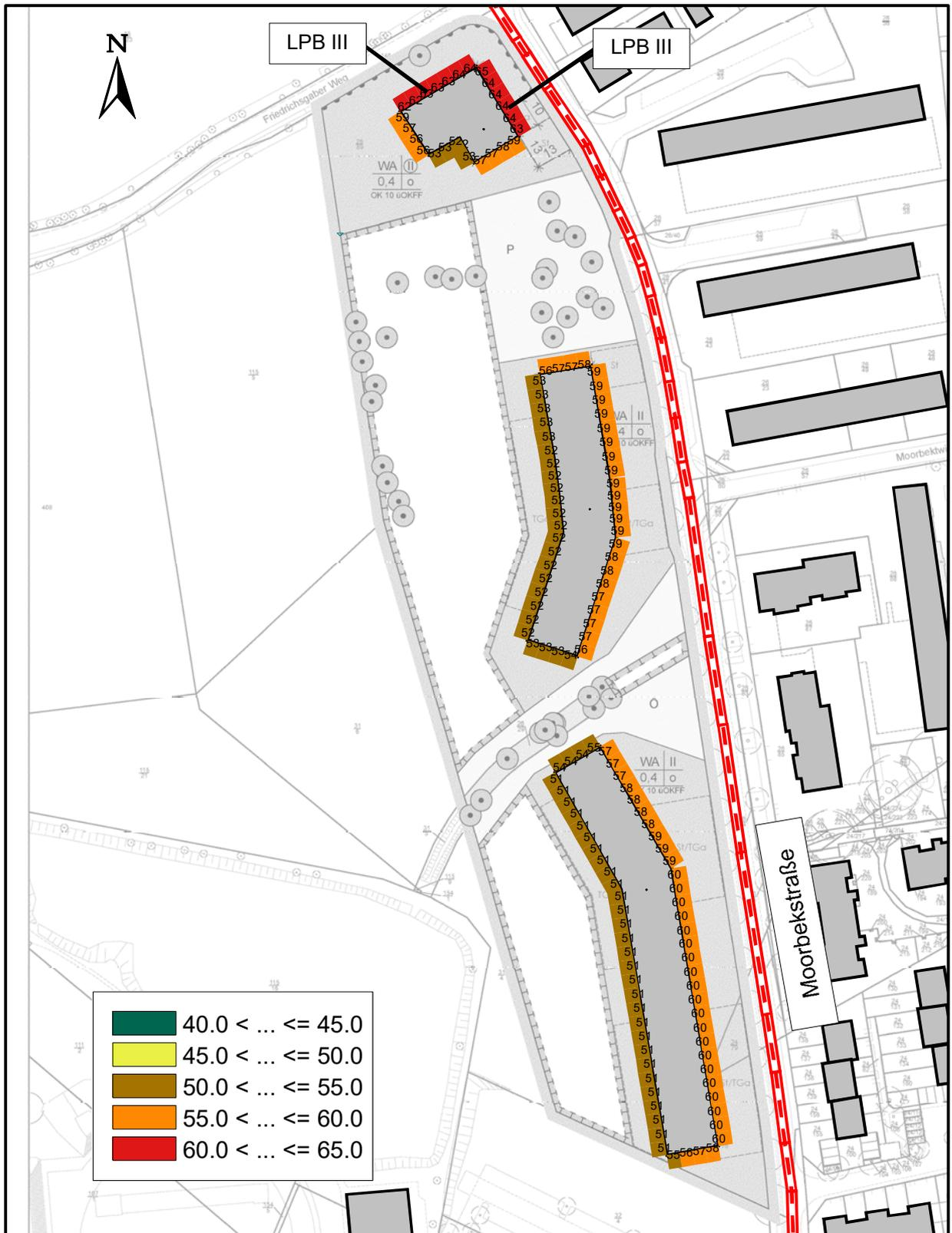
Abbildung 4. Lärmpegelbereiche nach DIN 4109 [dB(A)], Maßstab 1 : 2.000.
