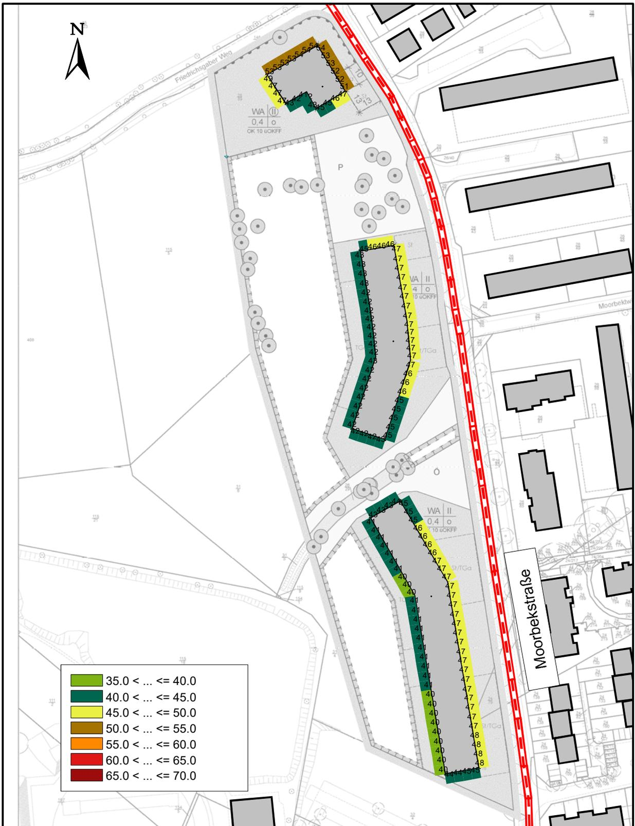
Abbildung 2. Fassadenscharfe Beurteilungspegel aus Verkehrslärm, nachts [dB(A)], Maßstab 1 : 2.000.
