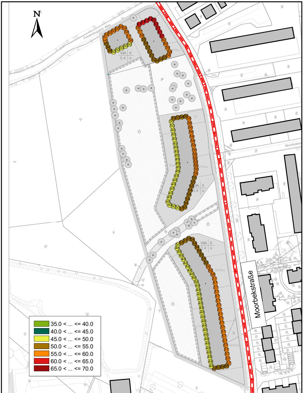
Abbildung 2. Fassadenscharfe Beurteilungspegel aus Verkehrslärm, tags [dB(A)], Maßstab 1 : 2.000.
