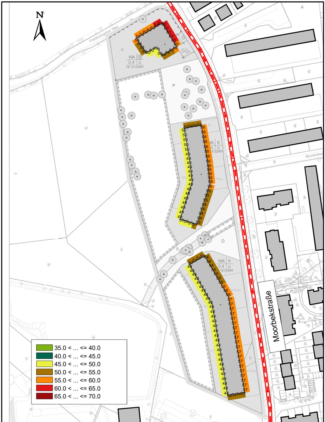
Abbildung 1. Fassadenscharfe Beurteilungspegel aus Verkehrslärm, tags [dB(A)], Maßstab 1 : 2.000.
