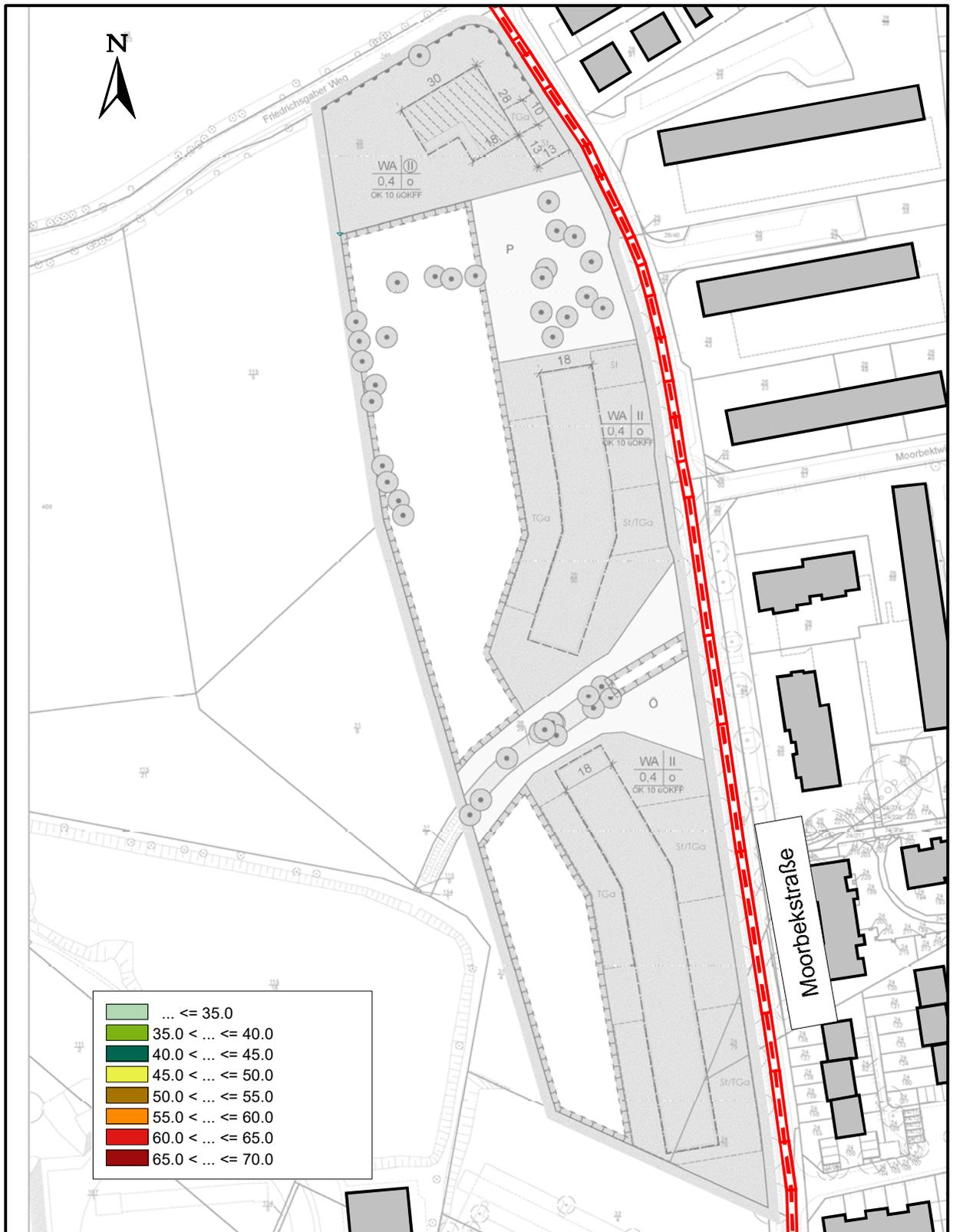
Abbildung 3. Beurteilungspegel aus Verkehrslärm, tags [dB(A)], ebenerdige Außenwohnbereiche (2 m über Gelände), Maßstab 1 : 2.000.
