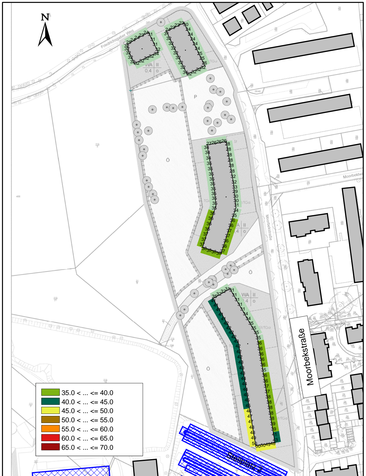
Abbildung 11. Fassadenscharfe Beurteilungspegel aus dem Schulbetrieb, tags [dB(A)], Maßstab 1 : 2.000.
