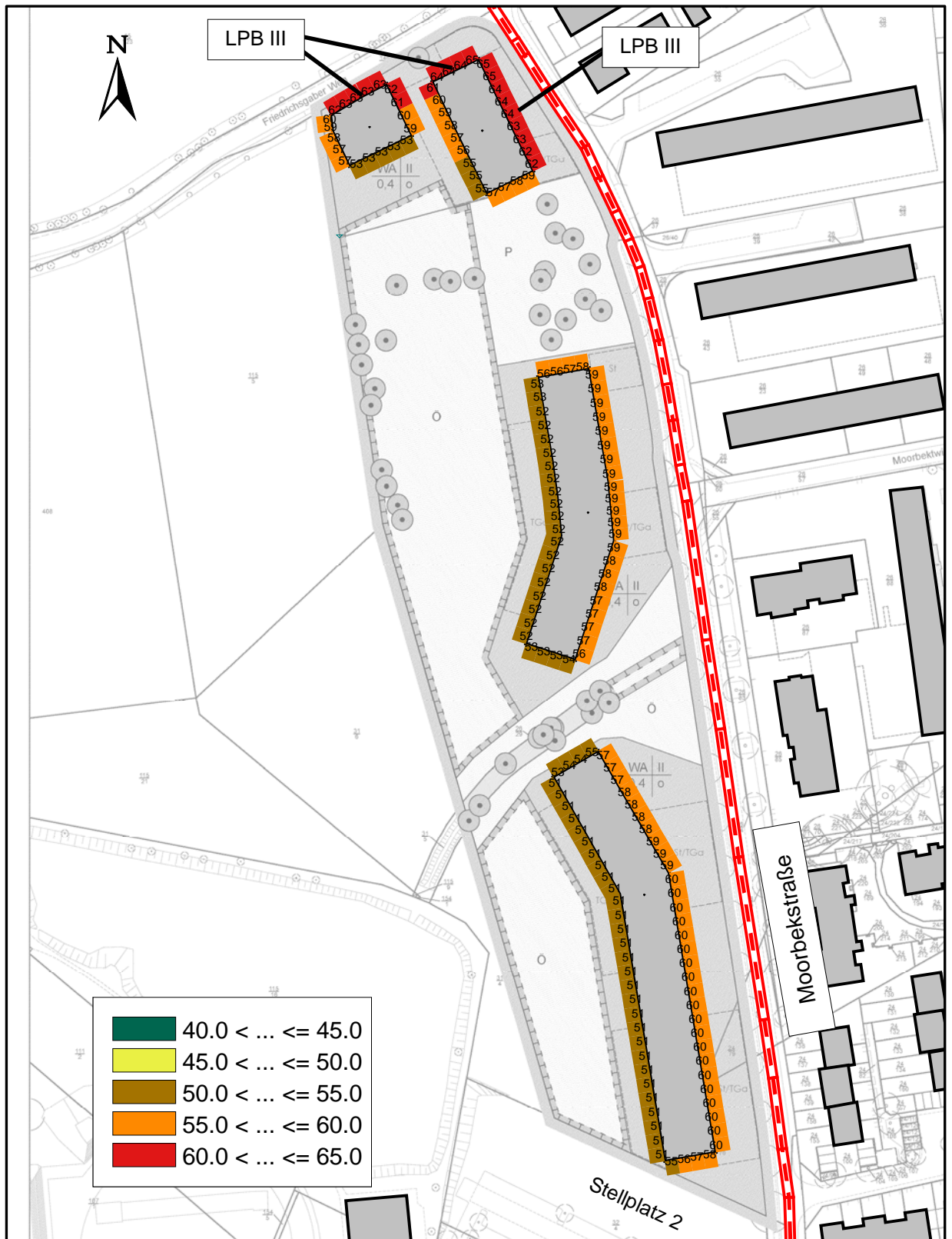
Abbildung 5. Lärmpegelbereiche nach DIN 4109 [dB(A)], Maßstab 1 : 2.000.
