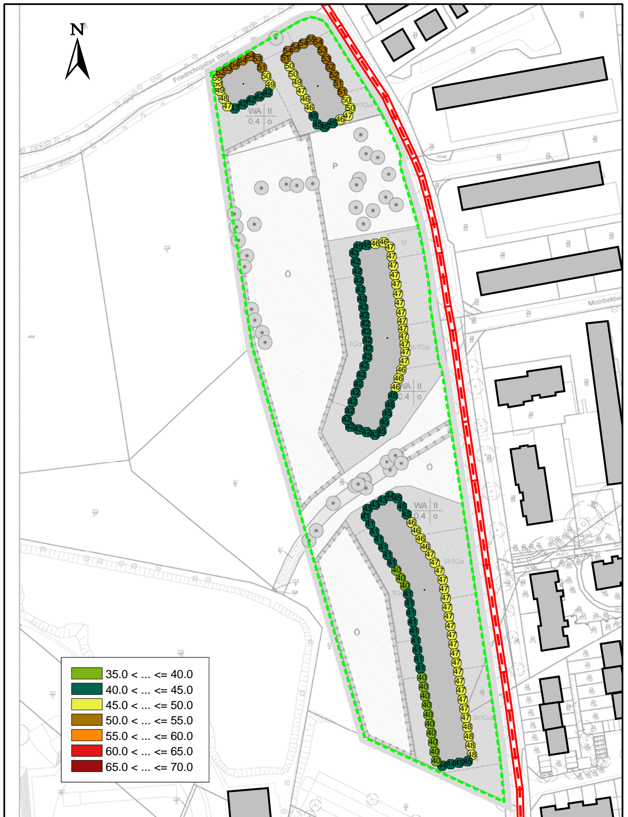
Abbildung 3. Fassadenscharfe Beurteilungspegel aus Verkehrslärm, nachts [dB(A)], Maßstab 1 : 2.000.
