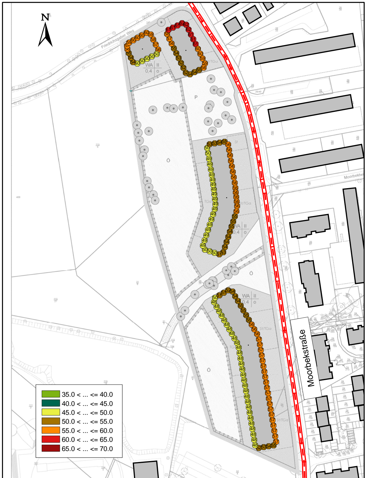
Abbildung 2. Fassadenscharfe Beurteilungspegel aus Verkehrslärm, tags [dB(A)], Maßstab 1 : 2.000.
