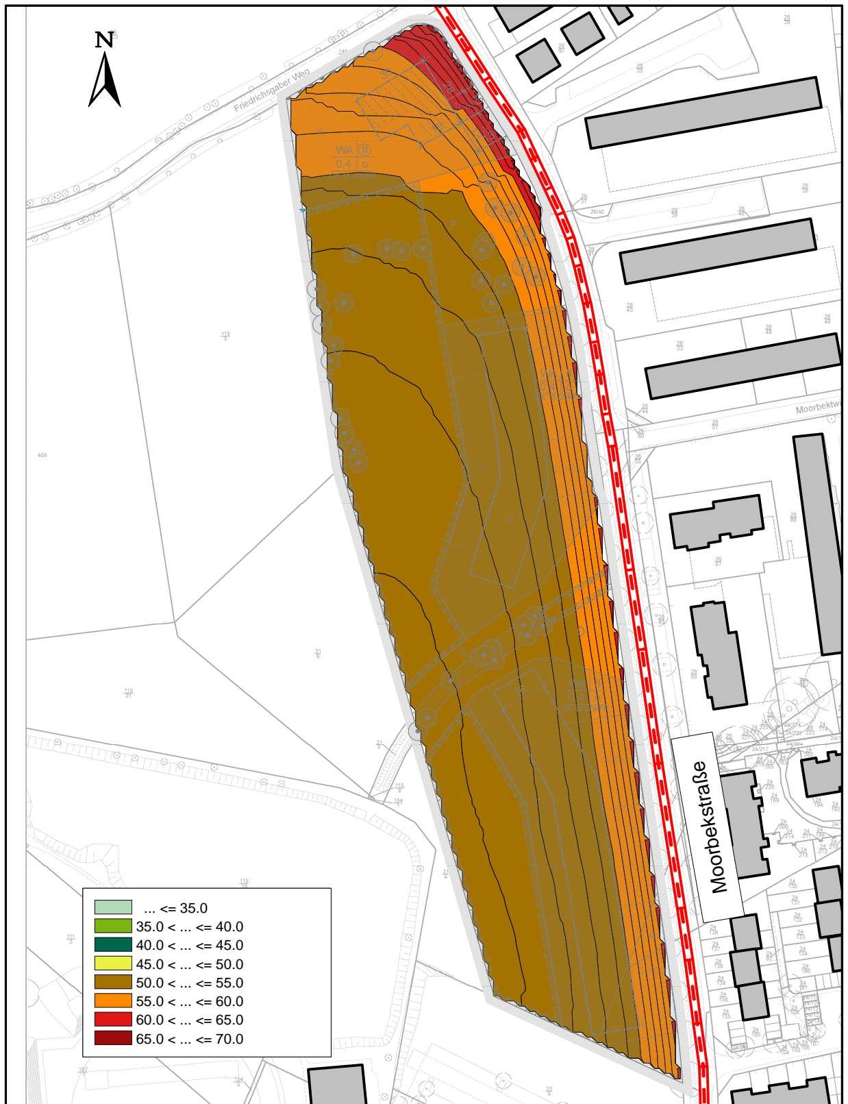
Abbildung 4. Beurteilungspegel aus Verkehrslärm, tags [dB(A)], ebenerdige Außenwohnbereiche (2 m über Gelände), Maßstab 1 : 2.000.
