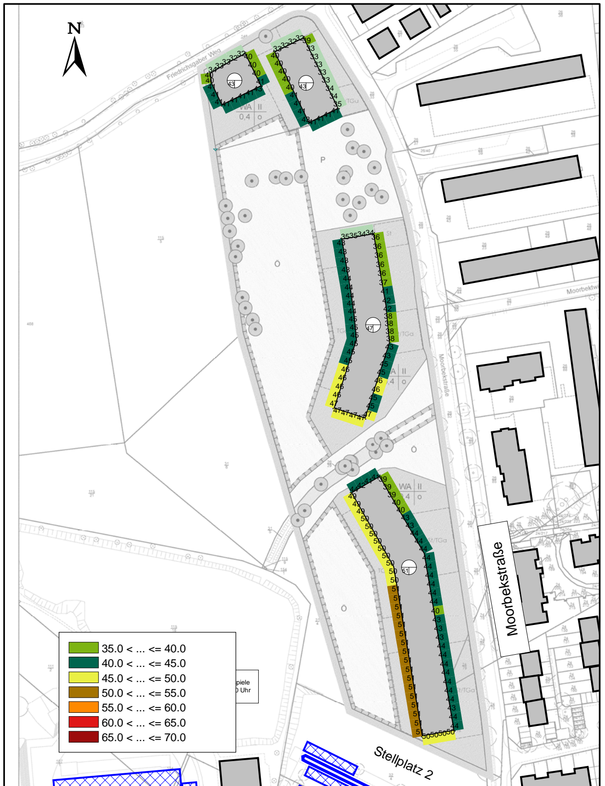
Abbildung 8. Fassadenscharfe Beurteilungspegel aus Sportlärm, Fußballpunktspiele, außerhalb der Ruhezeiten tags [dB(A)], Maßstab 1 : 2.000.
