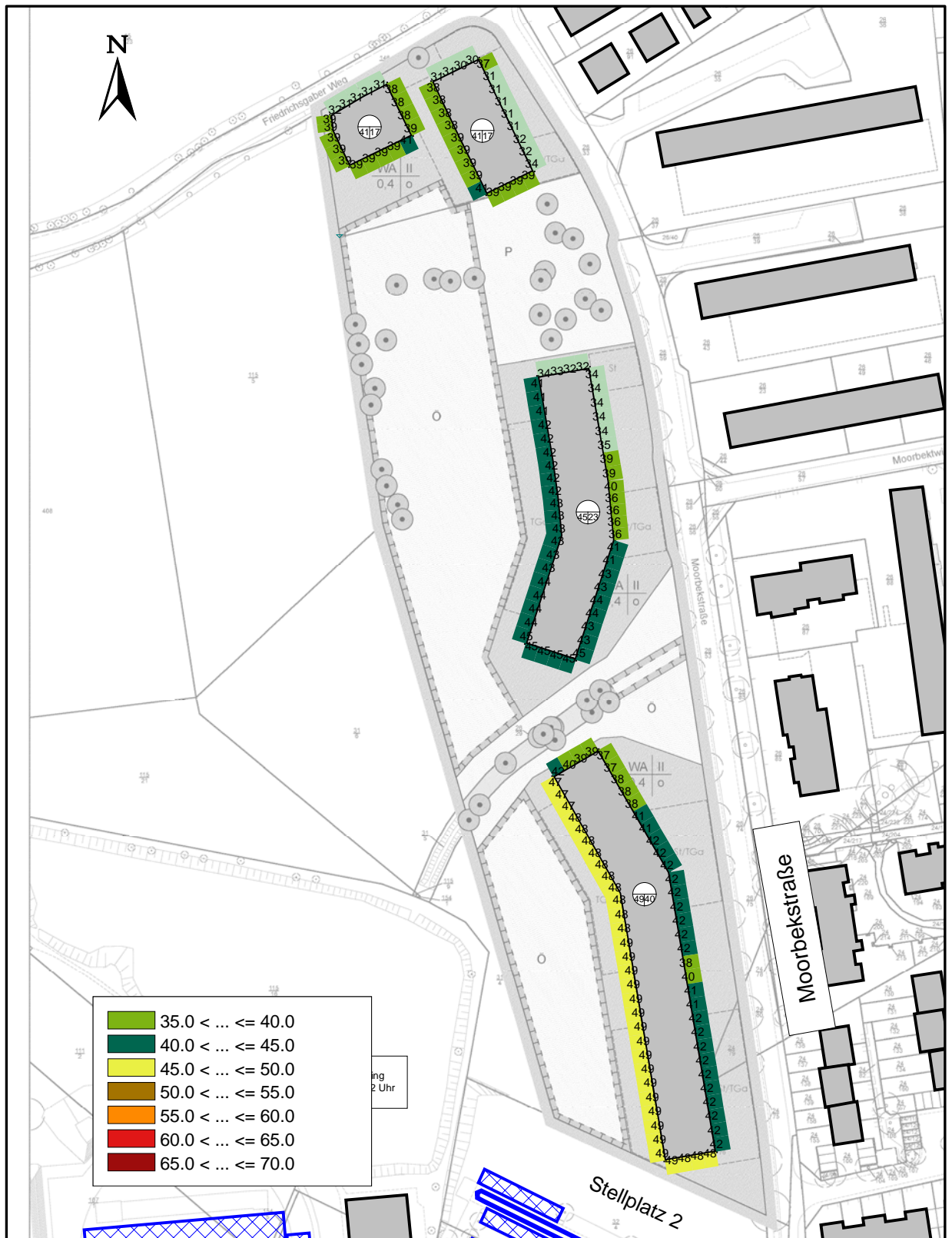
Abbildung 6. Fassadenscharfe Beurteilungspegel aus Sportlärm, Fußballtrainingspiele, innerhalb der Ruhezeiten tags [dB(A)], Maßstab 1 : 2.000.
