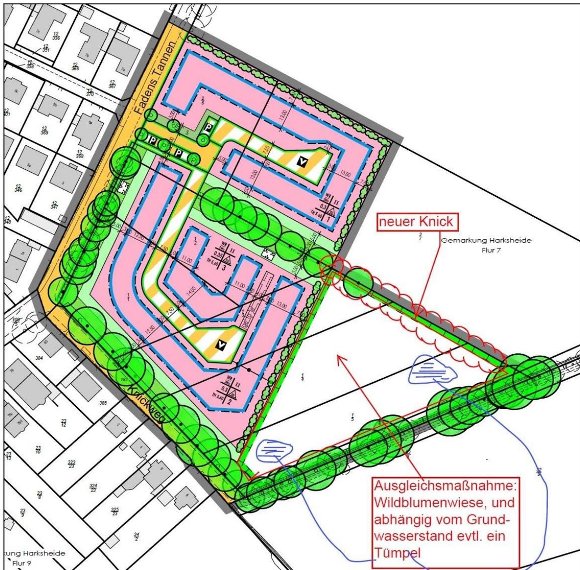
**Abbildung 3: Bebauungsplan-Entwurf (Stand 10.02.2015) und Ergänzungen zu Ausgleichsmaßnahmen 14.09.2015**
